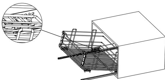
6. Отрегулируйте положение корзины в задвинутом состоянии по центру шкафа, затянув винты крепления направляющей.
