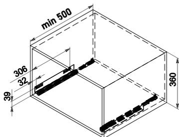
4. Установите фасадные крепления (1a) и крепления для направляющих (1b) с помощью винтов. Не затягивайте винты.
