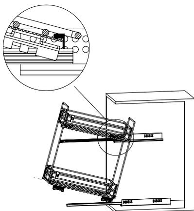
5. Отрегулируйте крепление к направляющим в задвинутом состоянии. Навесьте фасад и отрегулируйте его во всех плоскостях. Далее зафиксируйте фасад, затянув все винтовые соединения.
